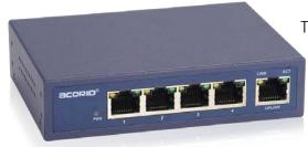
• La gamme de switchs PoE ACORID proposés en exclusivité par Tiptel. Cette nouvelle gamme comporte 7 modèles : 5 modèles en 10/100Mb (4, 8, 16 ou 24 ports) et 2 modèles en 1Gb (4 ou 8 ports), tous PoE et auto-adaptables. Ils sont particulièrement adaptés à l'usage de téléphonie sur IP afin de connecter des postes SIP sur le LAN. Ces switchs PoE fournissent l'alimentation et les données par un accès unique, utilisant
